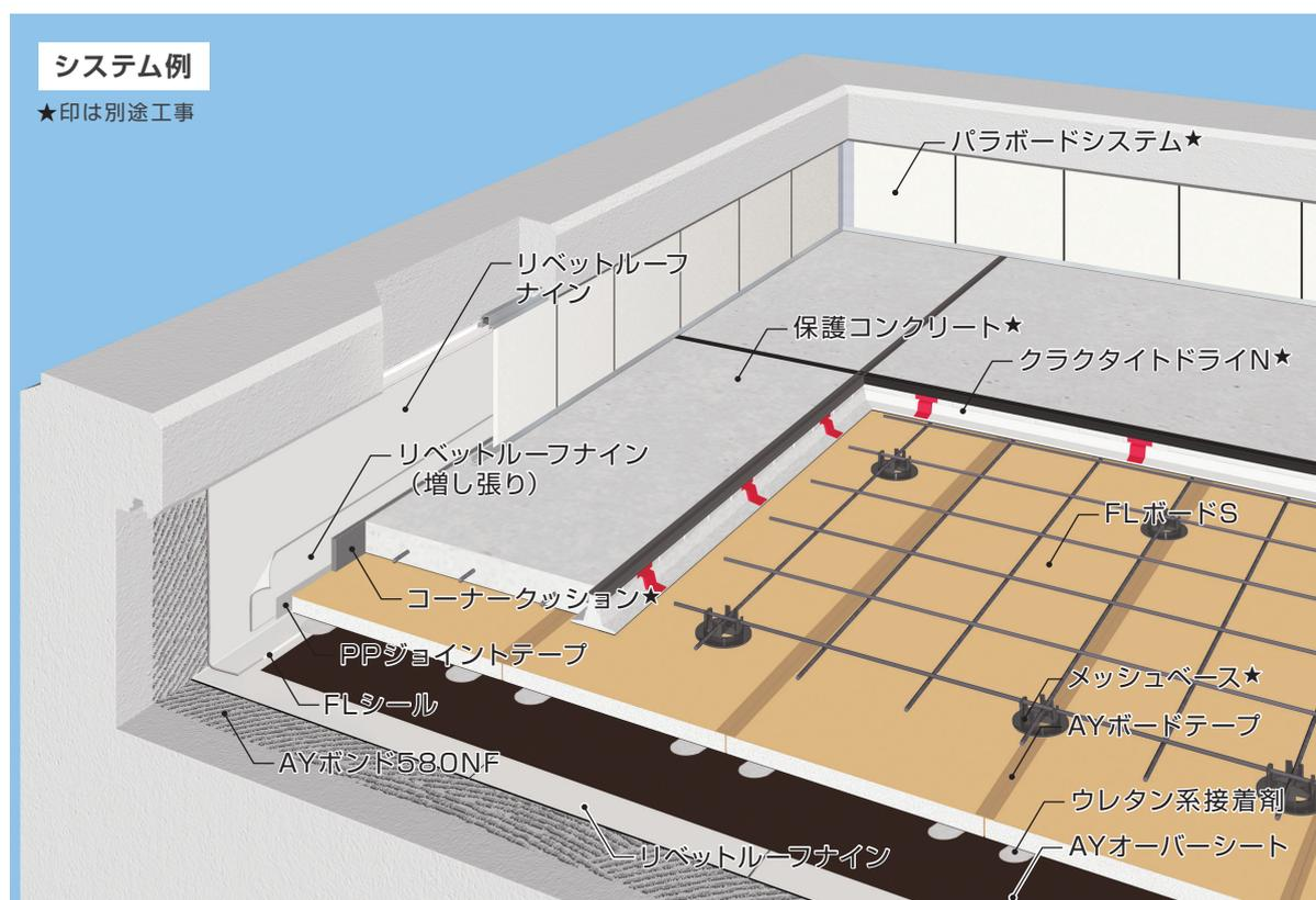
リベットルーフ防水システムの接着工法を採用し、保護コンクリートの打設を行う仕様です。防水層と保護コンクリートの間に断熱材を組み込むことにより、防水層の保護と断熱効果が期待できます。
