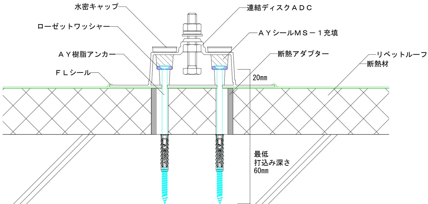
※上記は新築イメージ。改修時は、最低埋込み深さ50mm以上として、既存防水層の厚みを考慮してアンカー長を選定
